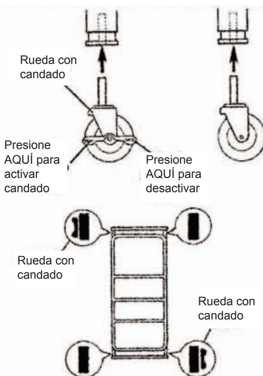
FIGURA 6 – ENSAMBLANDO LOS EXTREMOS DE LA CAMA
