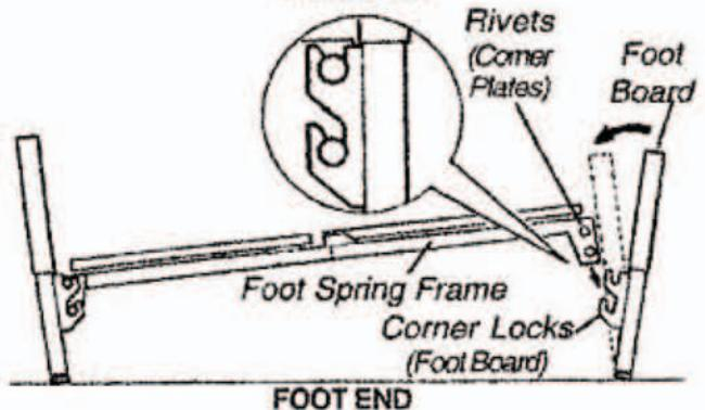
**FIGURE 6 - ASSEMBLING THE BED ENDS**
